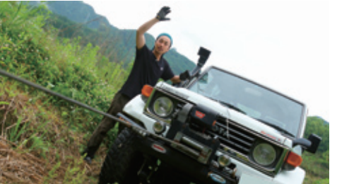
12.OXE ● RV用ウインチとしては最強の5440kgという牽引力を持つウインチ。モーターにクーリングシステムを備えているのが特徴だ。
