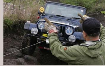
ハンドサインを覚えよう 1 指揮者からの支持は基本的にハ ンドサインで行う。基礎知識と して①人差し指を立クルクルと回す「ラインを巻け」②人差し 指を立てた腕を下で回す「ライ ンを出せ!」③手のひらを見せて 腕を高く上げる「ウインチス トップ」④腕を上げて人差し指 と親指をつけたり離したりする 「ちょっとずつ巻いて!」 の4つ。 上の写真はクルマの進行方向を 支持している。
