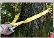
木をアンカーにする場合は、必ず ツリープロテクターを使用する。 樹皮を傷つけてしまわないため。
