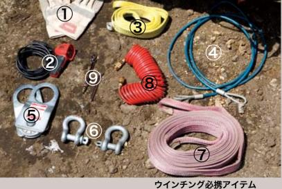
ウインチング時には①グローブ②リモコン③ ツリートランクプロテクター④補助ワイアー ウインチワイアーでの牽引は× ⑤スナッチブロック⑥U字シャックル⑦リカバリーストラップは最低限用意したいアイテ ワイアーを巻きとってスタック車両を引き 寄せるのではなく、ウインチワイアーでス ム。⑧⑨はDual Force HPのエアコンプレッ タック車両を牽引するのは×。ドラム内のブ サーで使用するアイテム。 レーキ(イラストのオレンジ部分)が破損し、 必要なときにブレーキが効かなくなってし
