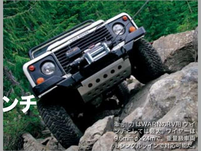
牽引力はWARNのRV用ウインチとしては最大。ワイヤーは9.5mmφ×24mで、重量級車両もシングルラインで対応可能だ。
