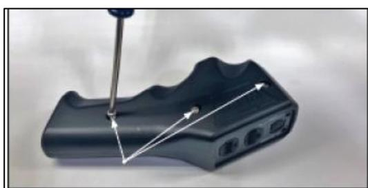
⑤バッテリーパックを外したら、リモートコントロールカバーを元に戻し、3つのネジを締めてください。
