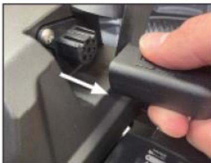
コントロールボックスのソケットからリモコンケーブルを外してください
