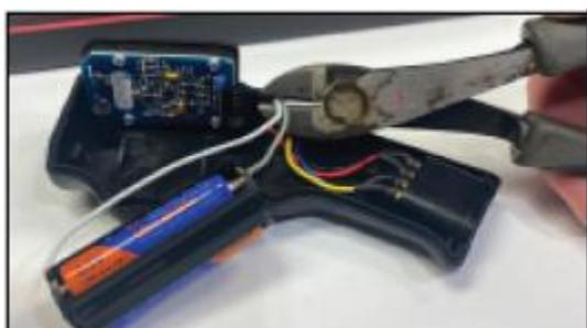
③リモートコントロールからバッテリーパックを外すため、白およびグレーの配線を切断してください。
