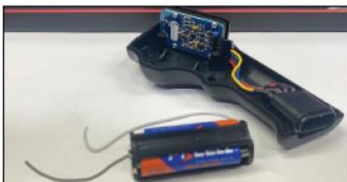
④リモートコントロール内部からバッテリーパックを外し、廃棄してください。
